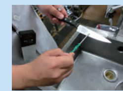
ATP拭き取り検査(清浄度の確認)
