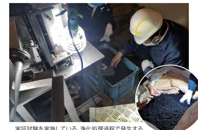
実証試験を実施している、浄化処理過程で発生する汚泥の燃料化。有機性廃液を脱水処理した際に残る汚泥を脱塩・乾燥し、化石燃料に代わる固形燃料として再生する。
