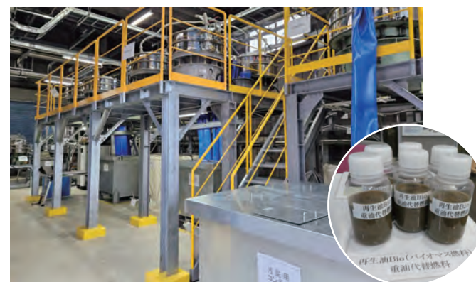
飲食店や食品工場から排出される廃液から、油分のみを分離回収し、重油代替燃料「再生油B i o」。ニーズに対応し、2024年3月には製造ラインを2倍に増強し、製造能力4,320 t/年とした。
