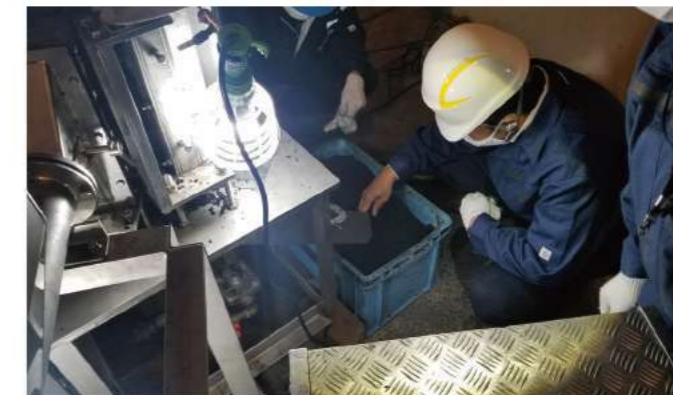
浄化処理過程で発生する汚泥の燃料化について、2020年10月より、実証試験を本格開始。有機性廃液を脱水処理した際に残る汚泥を脱塩・乾燥し、化石燃料に代わる固形燃料にする。2023年度の事業開始、年間5,400トンの燃料製造を目指している。
