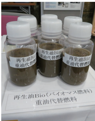
飲食店や食品工場から排出される廃液から油分のみを分離した重油代替燃料「再生油 Bio」。環境負荷の低い製品として、「令和3年度北九州エコプレミアム」第15回 福岡県産リサイクル製品」などの公的な評価を受けている。
